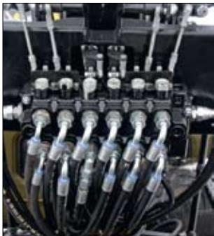
Гидрораспределитель спроектирован и произведен специально для этого крана. Обеспечивает высокую точность и плавность выполнения операций.
