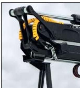
В конструкции рукоятки предусмотрен специальный упор для обеспечения опоры на платформу.
