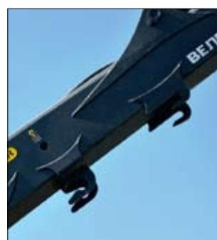
Два зацепа на стреле надежно фиксируют рукоять и грейфер в транспортном положении.
