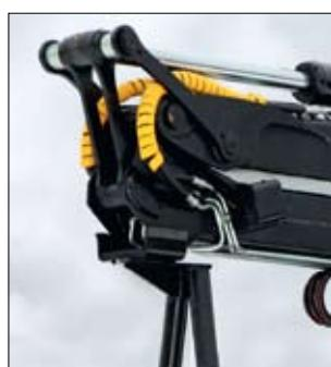
В конструкции рукояти предусмотрен специальный упор для обеспечения опоры на платформу.
