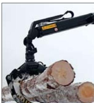
Рукава, идущие к ротору, полностью защищены от негативного механического воздействия: они проходят сквозь принципиально новую, запатентованную Epsilon, подвеску Epslink и не образуют висящие по сторонам петли.
