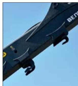
Два зацепа на стреле надёжно фиксируют рукоять и грейфер в транспортном положении.
