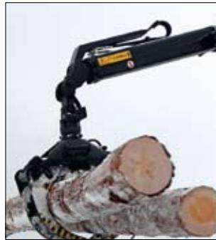
Рукава, идущие к ротатору, полностью защищены от негативного механического воздействия: они проходят сквозь принципиально новую, запатентованную Epsilon, подвеску Epslink и не образуют висящие по сторонам петли.
