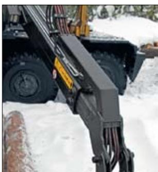
Диаметр трубопроводов и РВД рассчитан оптимально. Специально разработанный кожух надежно защищает РВД на удлинителе от внешних механических повреждений.
