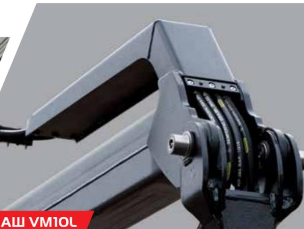
Диаметр трубопроводов и РВД рассчитан оптимально. Специально разработанный кожух надежно защищает РВД на удлинителе от внешних механических повреждений.
